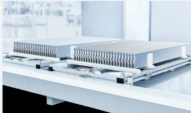
Die Zellen der Blade-Batterie auf Lithium-Eisenphosphat-Basis sind prismatisch, lang, schmal und dünn und werden direkt ins Batteriegehäuse integriert. Es gibt keine Module. Das spart Platz und Gewicht und vermindert so den Performance-Nachteil.
